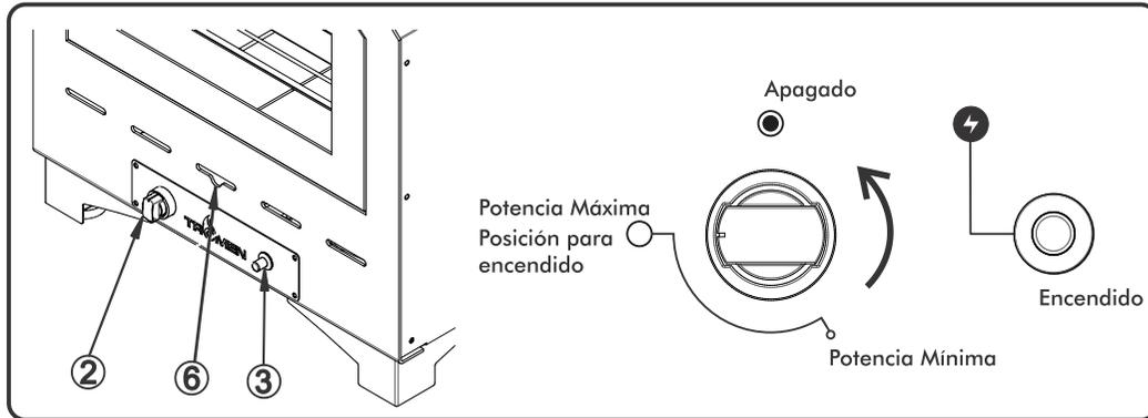
Encendido asistido del quemador.
