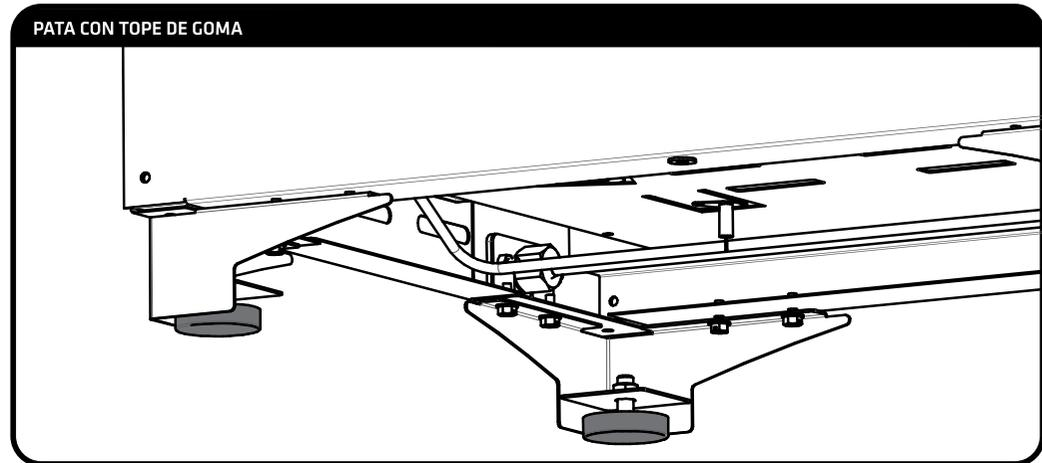
**i** Durante la instalación de todos los modelos de horno usted puede realizar la regulación fina en altura de las patas, roscando o desenroscando las patas roscadas provistas con su equipo.
